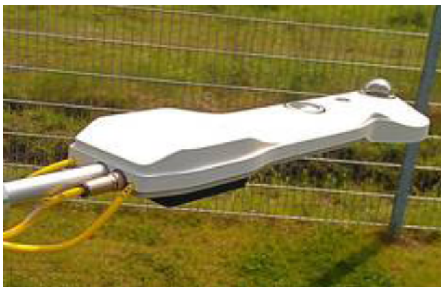
Der neue Strahlungsbilanzsensor der Klimatologie, der auch in den Lehrveranstaltungen zum Einsatz kommt.
