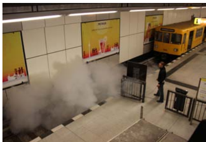
Verrauchungsversuch in einer U-Bahnstation
