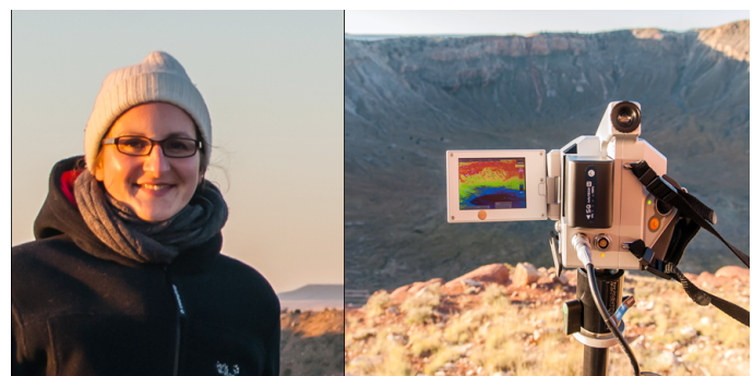
Martina Grudzielanek und ihre Thermokamera zur Erfassung von Lufttemperaturen durch Infrarotmessung
